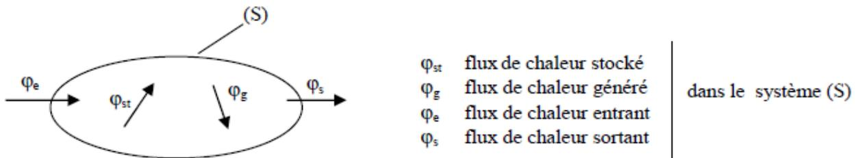
On applique alors le 1er principe de la thermodynamique pour établir le bilan d'énergie du système (S) :
