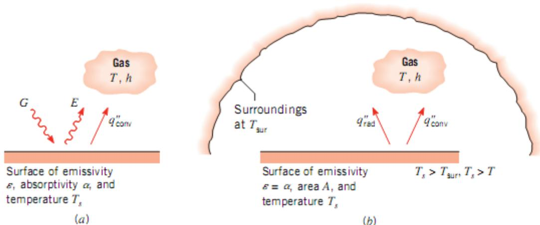
Le rayonnement émis par la surface provient de l'énergie thermique de la matière délimitée par la surface, et la vitesse à laquelle l'énergie est libérée par unité de surface (W / m<sup>2</sup>) est appelée puissance émissive de surface, E. Il y a une limite supérieure le pouvoir émissif, qui est prescrit par la loi Stefan-Boltzmann.
