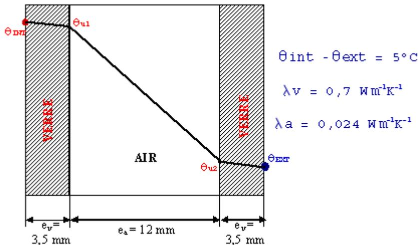
Le flux traversant ce double vitrage est donné par :
